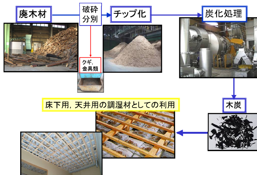
図1 廃木材を利用した調湿用木炭の製造とその利用
