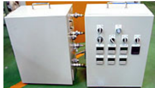
図-3 システム中の水冷水切り替えボックス
