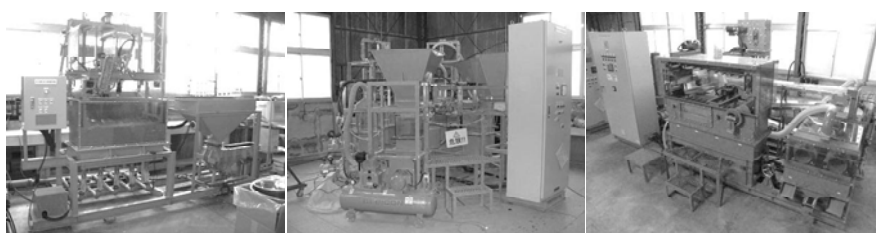
図2 浮き沈みしたものを取り出すことが可能な分離装置
