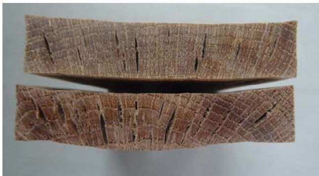
内部割れの発生状況 上：辺材、下：心材
