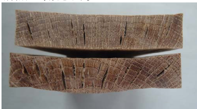
内部割れの発生状況 上：辺材、下：心材
